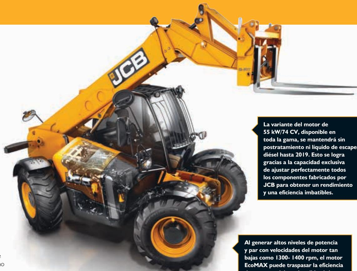
La variante del motor de 55 kW/74 CV, disponible en toda la gama, se mantendrá sin postratamiento ni líquido de escape diésel hasta 2019. Esto se logra gracias a la capacidad exclusiva de ajustar perfectamente todos los componentes fabricados por JCB para obtener un rendimiento y una eficiencia imbatibles.
