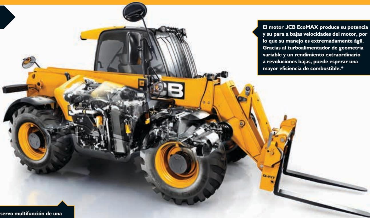
El motor JCB EcoMAX produce su potencia y su para a bajas velocidades del motor, por lo que su manejo es extremadamente ágil. Gracias al turboalimentador de geometría variable y un rendimiento extraordinario a revoluciones bajas, puede esperar una mayor eficiencia de combustible.\*
