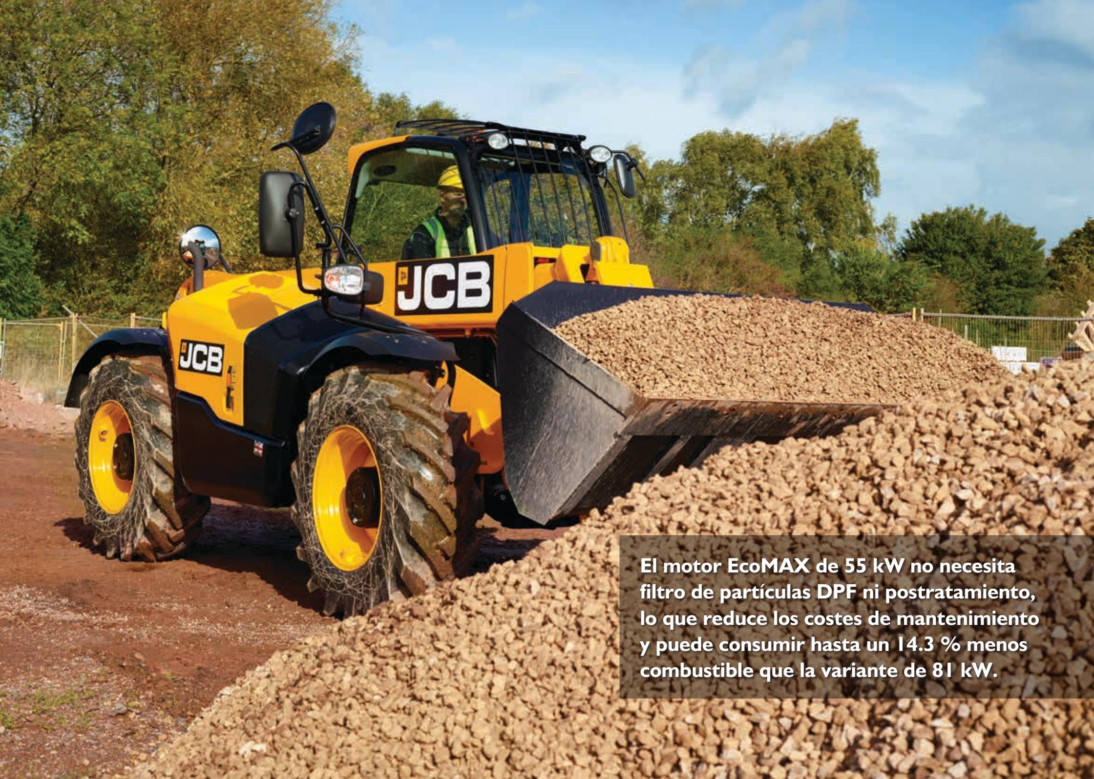
**El motor EcoMAX de 55 kW no necesita filtro de partículas DPF ni postratamiento, lo que reduce los costes de mantenimiento y puede consumir hasta un 14.3 % menos combustible que la variante de 81 kW.**
